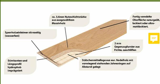
3-Schicht Aufbau zur vollflächigen Verklebung oder schwimmenden Verlegung
